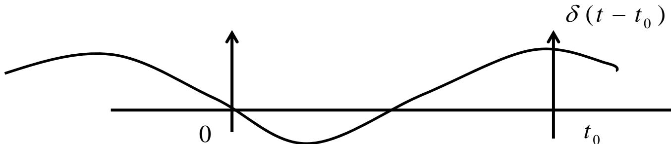
$$f(t) \cdot \delta(t - t_0) = f(t_0)\delta(t - t_0)$$
