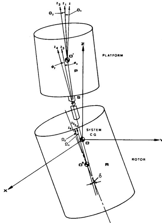
Figure 1. Dual-Spin Satellites
